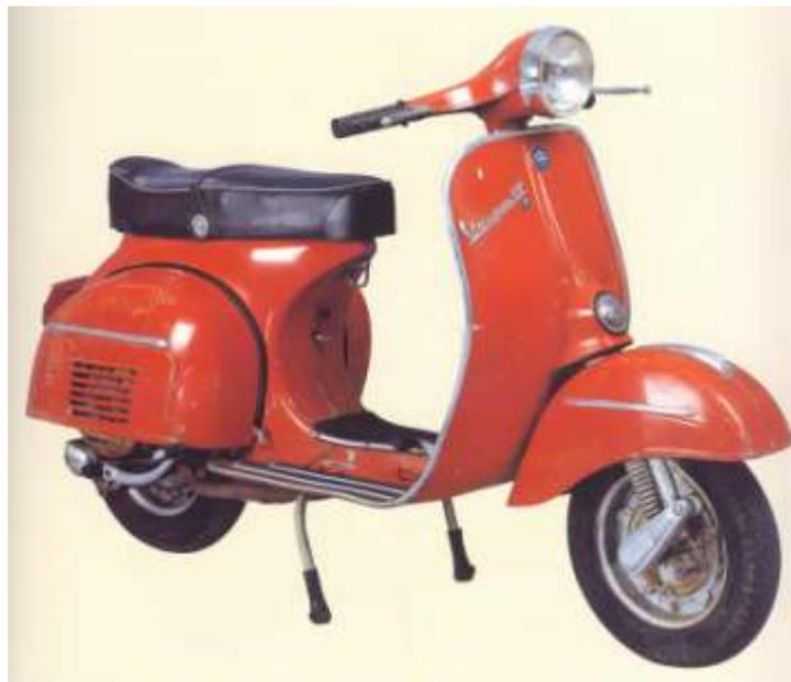
Anche per questo modello il motore è l'ormai classico due tempi a cilindro orizzontale con raffreddamento forzato ad aria con la particolare ammissione a distribuzione rotante che permette l'uso della miscela al 2%. Altre caratteristiche del propulsore sono; alesaggio di 52,5 mm e la corsa di 57 mm per una cilindrata esatta di 123,4 cc.
