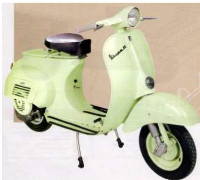
Lo sportellino di ispezione del motore ha dimensioni ridotte, infatti fu in seguito modificato, ingrandendolo nella parte alta in modo da accedere alla sostituzione o alla pulizia della candela con maggior facilità.
