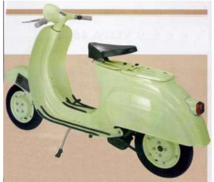
La pedana poggiapiedi della Vespa 50 ha i profili in gomma, senza i listelli ed i terminali in alluminio. I due fori filettati sul piantone di sterzo, servono per la staffa del porta ruota di scorta. Molto ben curato il fanalino posteriore, realizzato dalla Siem, con la base in lega di alluminio. Al centro del trasparente rosso c'è il catadiottro con cornicetta di metallo.
