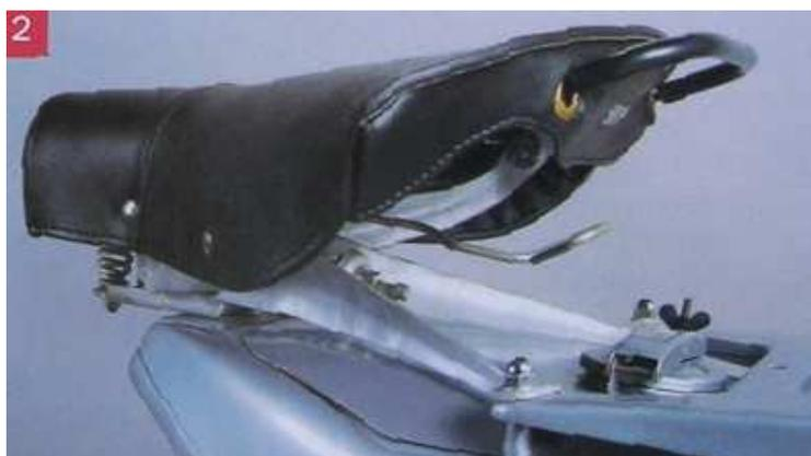
2) La sella è rimasta quella della VL3, caratterizzata dalle due piastre di attacco che si allungano fino ai due dadi di fissaggio del serbatoio.
